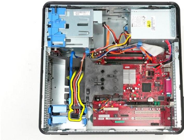
4. Desconecte o cabo de alimentação da unidade óptica.
