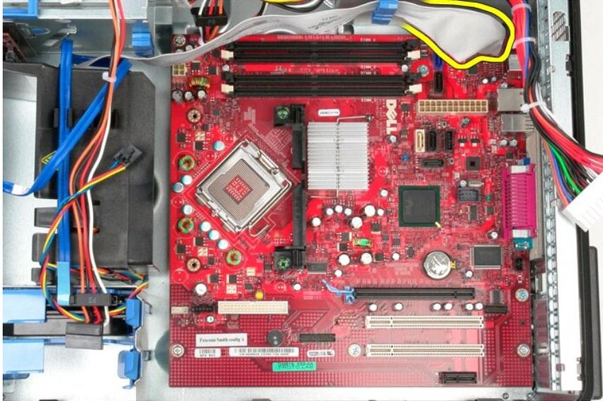
11. Remova os dois parafusos que prendem o suporte do conjunto do dissipador de calor à placa do sistema.
