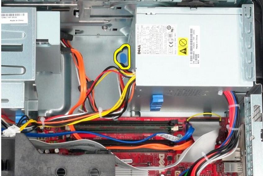
10. Deslize a fonte de alimentação em direção à frente do computador e levantando-a, retire-a do computador.
