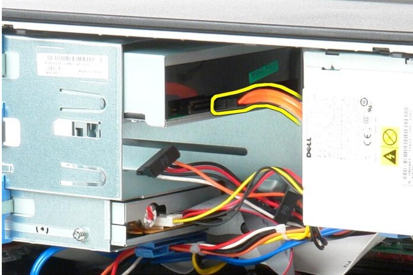
5. Mova a trava de liberação da unidade em direção à parte inferior do computador e retire a unidade óptica do computador.
