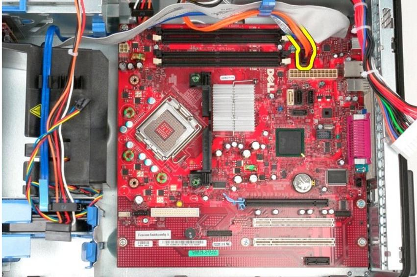
9. Desconecte o cabo de dados do disco rígido da placa do sistema.
